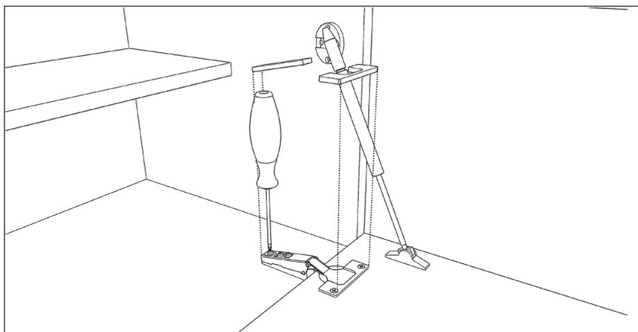
Se l'anta a ribalta dovesse decentrarsi, agire con un cacciavite sulla vite più interna delle cerniere, fino a riportare l'anta in posizione centrata.
