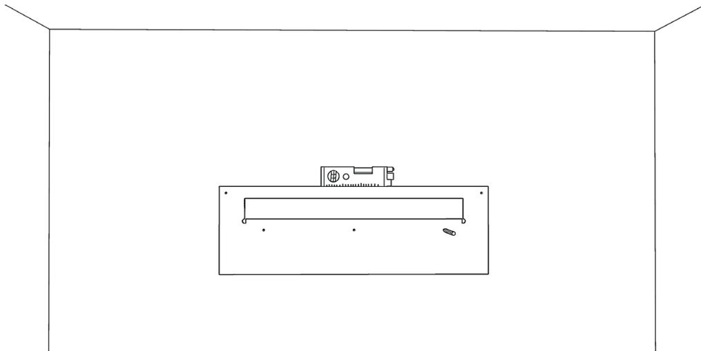
Posizionare la maschera sulla parete: Con l'ausilio di una livella verificare l'orizzontalità. Con la matita segnare la posizione dei fori.
