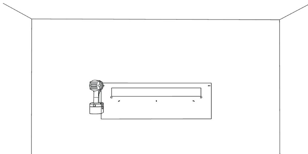
Utilizzare un avvitatore per ancorare a parete la maschera con n. 5 viti.
