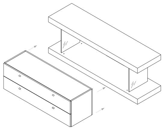
Con il telaio completato, inserire la cassettiera consultando le relative schede di montaggio riguardo lo slittamento all'interno del vano libreria.
