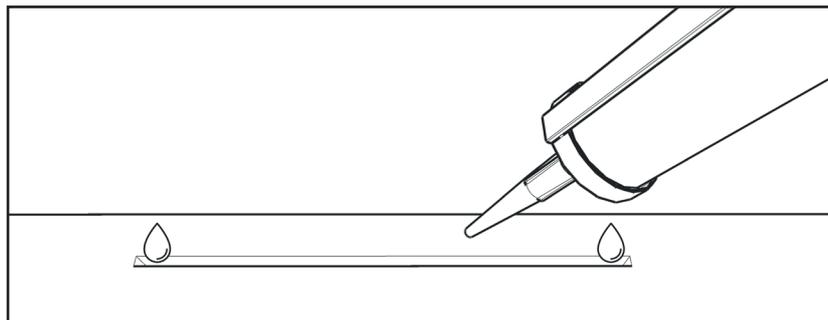
Applicare una piccola quantità di silicone solo agli estremi interni delle incisioni, al fine di garantire una facile futura rimozione delle spallette dalle mensole.
