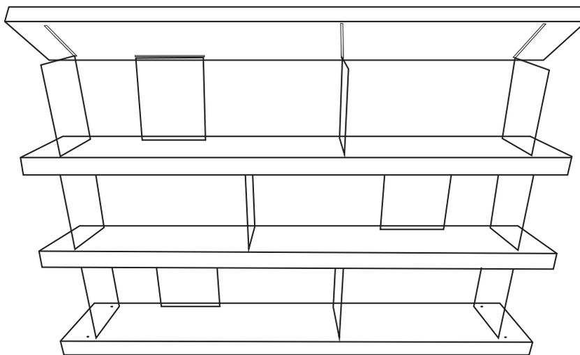
Posizionare la mensola numero 4 sulle spallette di vetro già montate sulle mensole numero 3. Allineare tutte le spallette in corrispondenza delle fessure. Fare pressione sulla mensola, assicurandosi che le spallette di vetro siano inserite fino in fondo nelle rispettive fessure.
