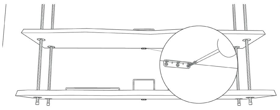
Ancorare alla parete le mensole n. 4 e n. 5 tramite l'ausilio di staffe angolari di fissaggio. Posizionare n. 1 squadretta per mensola nella mezzeria e avvitare n. 6 viti per ciascuna staffa.
