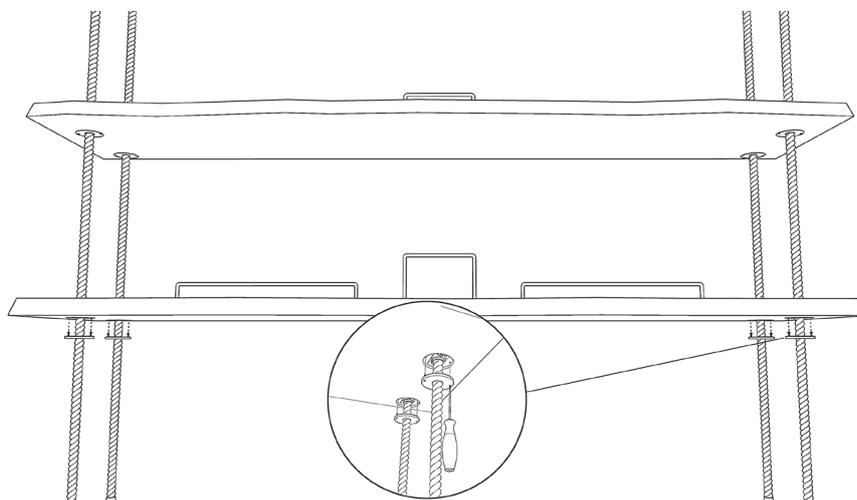
Rimuovere le dime e spingere la mensola fino a inserire i collarini nell'apposita sede. Prendere n. 4 rondelle copriforo e infilarne una per ciascuna delle 4 funi. Far aderire la rondella nell'apposito spazio e serrare ciascuna con n. 2 viti mediante l'uso di un cacciavite o di un avvitatore.
