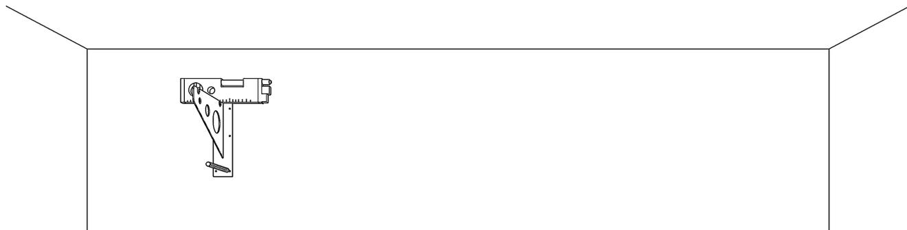
Disporre una delle staffe a un'altezza minima di 240 cm; essa costituirà il supporto sinistro di sostegno della libreria. Utilizzare una livella per verificare l'orizzontalità del sostegno e apporre un segno con la matita in prossimità dei fori della maschera.
