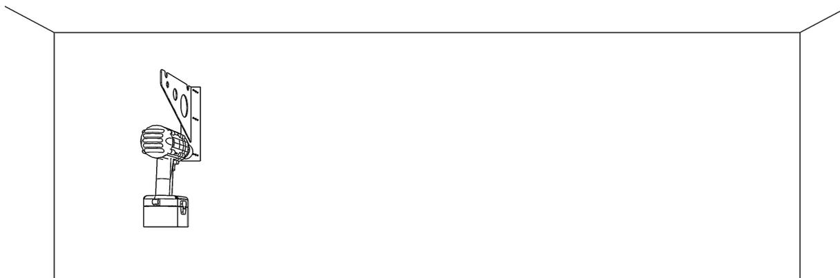
Ricollocare la staffa sulla parete facendo combaciare i fori della maschera con quelli della parete. Usare un avvitatore o cacciavite per inserire e serrare n. 6 viti a parete
