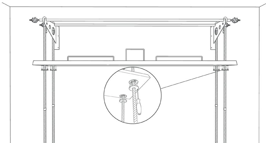
Rimuovere le dime e spingere la mensola fino a inserire i collarini nell'apposita sede. Prendere n. 4 rondelle copriforo e infilarne una per ciascuna delle 4 funi. Far aderire la rondella nell'apposito spazio e serrare ciascuna con n. 2 viti mediante l'uso di un cacciavite o di un avvitatore.
