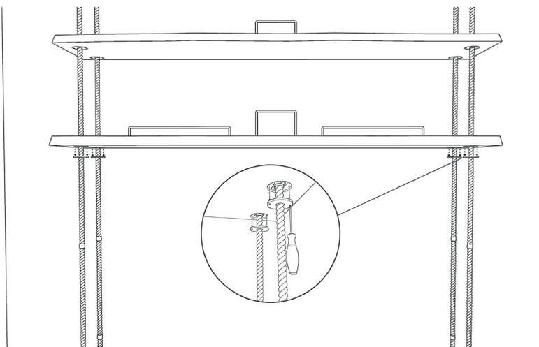
Rimuovere le dime e spingere la mensola fino a inserire i collarini nell'apposita sede. Prendere n. 4 rondelle copriforo e infilarne una per ciascuna delle 4 funi. Far aderire la rondella nell'apposito spazio e serrare ciascuna con n. 2 viti mediante l'uso di un cacciavite o di un avvitatore.
