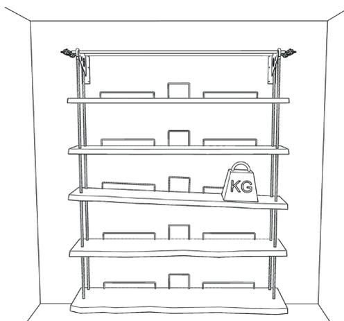
IL CARICO POTREBBE TENSIONARE LE CORDE. NEL CASO IN CUI SI VERIFICASSE UN DISALLINEAMENTO DELLE FUNI, RIVERIFICARE L'ORIZZONTALITÀ DELLA MENSOLA CON L'AUSILIO DELLA LIVELLA. PER RIPORTARE LA MENSOLA SULL'ASSE ORIZZONTALE AGIRE SUI COLLARINI.
