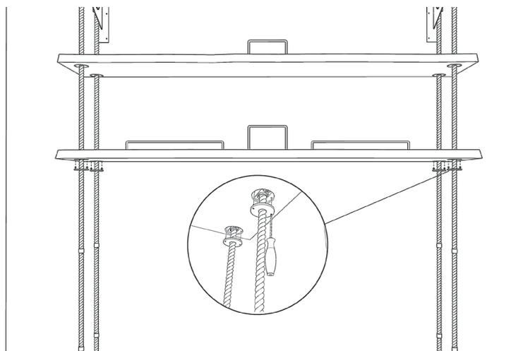
Rimuovere le dime e spingere la mensola fino a inserire i collarini nell'apposita sede. Prendere n. 4 rondelle copriforo e infilarne una per ciascuna delle 4 funi. Far aderire la rondella nell'apposito spazio e serrare ciascuna con n. 2 viti mediante l'uso di un cacciavite o di un avvitatore.
