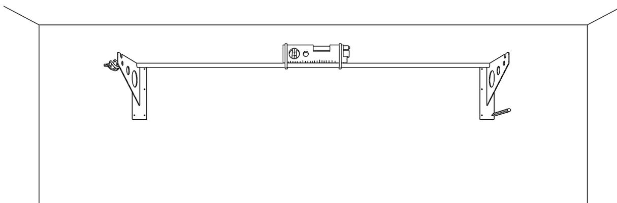
Mediante l'uso di elastici agganciare la livella a uno dei tubi, per poter allineare la staffa ancora a disposizione con quella precedentemente ancorata. L'interasse tra le staffe deve essere di 171 cm. Apporre un segno con la matita in prossimità dei fori della maschera.
